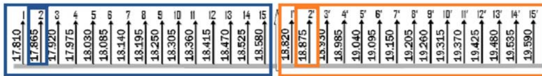
CNAF canales banda de 18 GHz canalización 55 MHz
